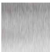
Revestimento em aço inox escovado
